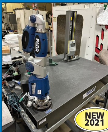
FARO Gage Plus Portable CMM
